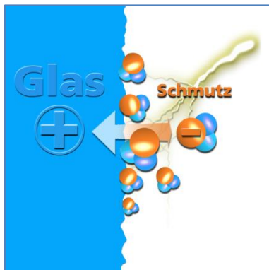
Schmutz wie beispielsweise Kalk kann Verätzungen auf der Oberfläche verursachen – die dauerhafte Barriere "Glas auf Glas" reduziert das Anlagern von Verschmutzungen.
